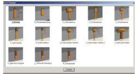
Wählen Sie in diesem Dialogfeld eine der Bohrformen aus, die als Symbol mit den entsprechenden Nennbezeichnungen abgebildet sind.
