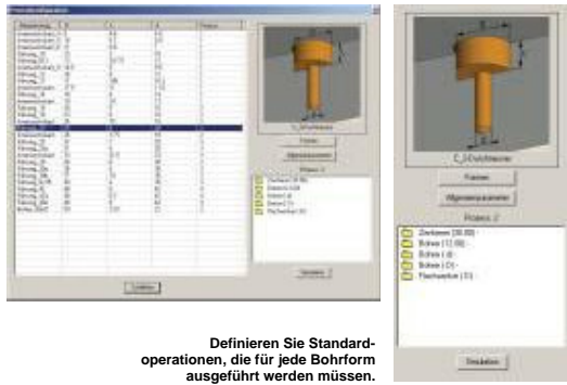
Wählen Sie in diesem Dialogfeld eine der Bohrformen aus, die als Symbol mit den entsprechenden Nennbezeichnungen abgebildet sind.
