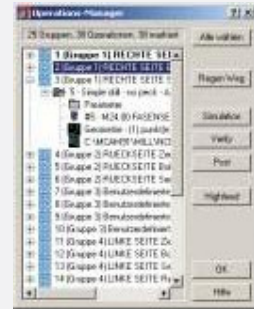
Im Operations-Manager können Sie die Werkzeugwege simulieren oder mit der Verify-Funktion überprüfen.
